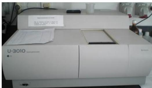
**Figura 2.6.** Espectrofotómetro de absorção molecular no UV/VIS
