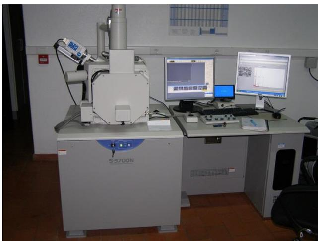
Figura 2.4. Microscópio eletrônico de varrimento com detector de EDS
