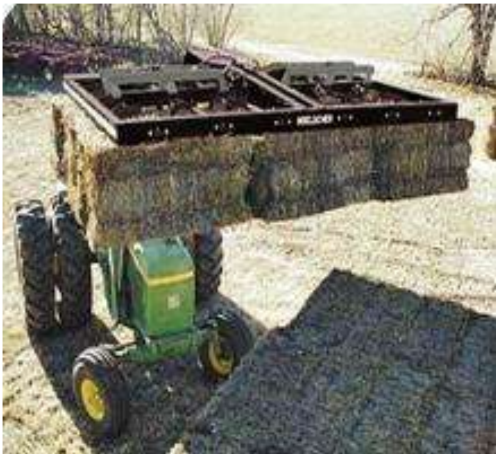
Fig nº 28 - Forquilha especial para fardos, aplicável num carregador frontal
