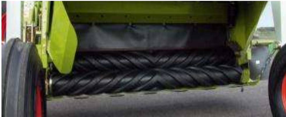
Fig nº 13 – Gadanheira condicionadora de rolos para condicionamento da forragem.
