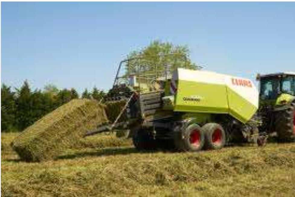
Fig nº 20 - Enfardadeiras de grandes fardos cilíndricos e paralelepípedicos
