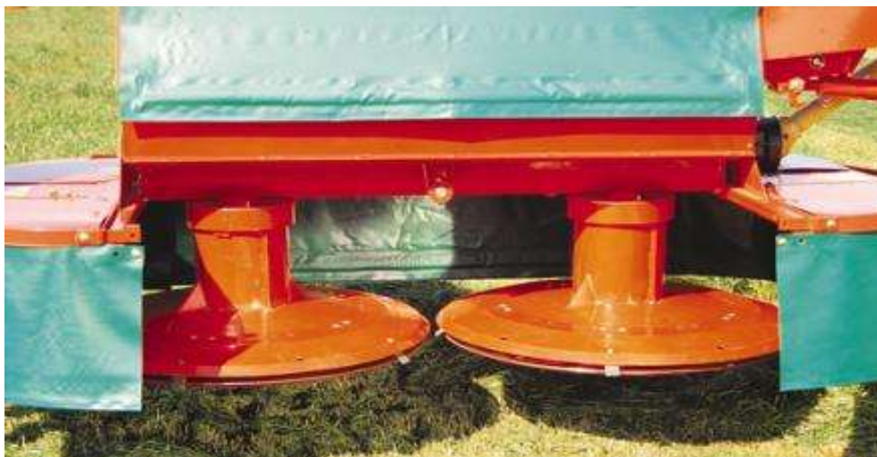
Fig nº 7 - Gadanheira rotativa de eixo vertical de tambores
