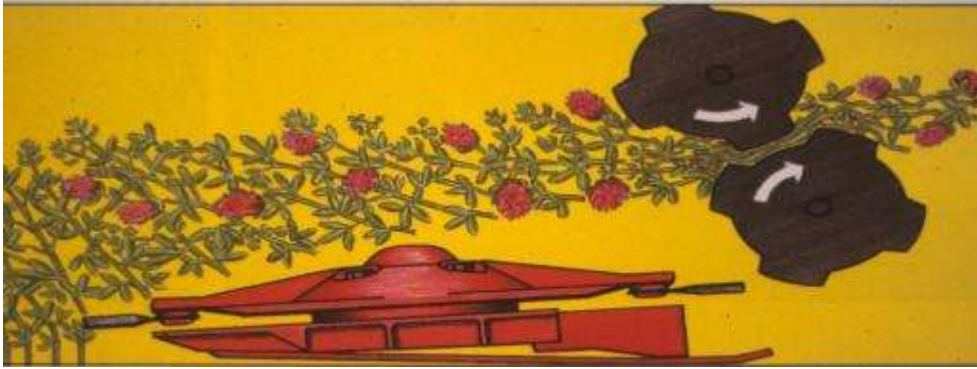
Fig nº 11- Rolos metálicos, canelados e cobertos por borracha
