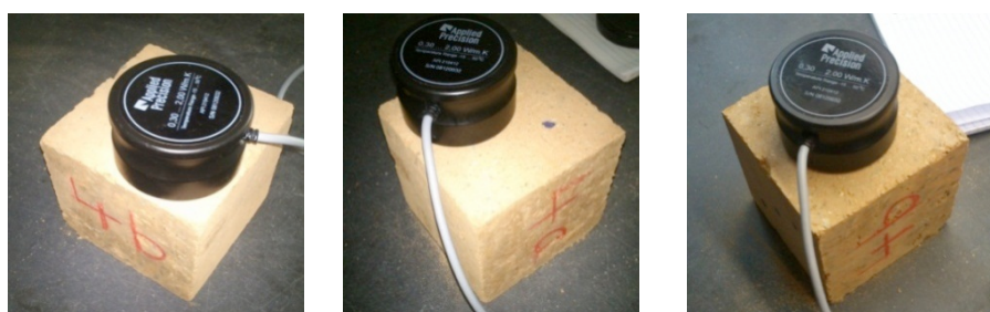
Figura 9. Determinação da condutibilidade térmica nas diferentes faces de um provete.
