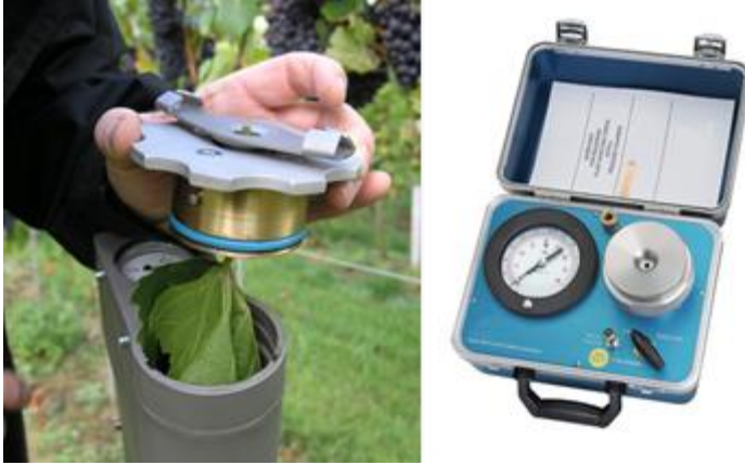
Figura 9.8. A câmara de Scholander. Uma folha é inserida na câmara com o pecíolo à mostra. A câmara é depois sujeita a pressões que podem ir até aos 20 bars, até que se veja a água no pecíolo da folha.
