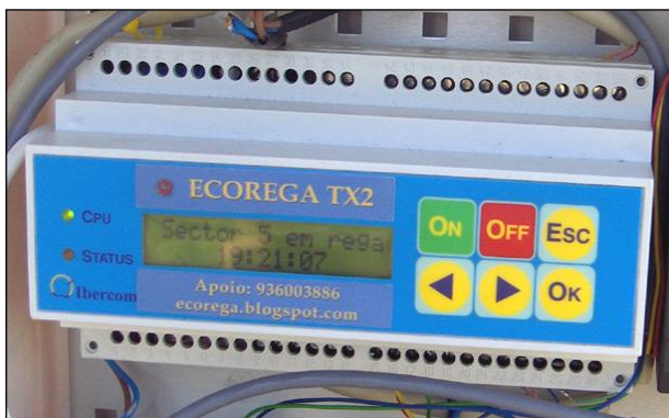
Figura 9.2 Aspecto do controlador de rega inteligente Ecorega TX desenvolvido pela Universidade de Évora.
