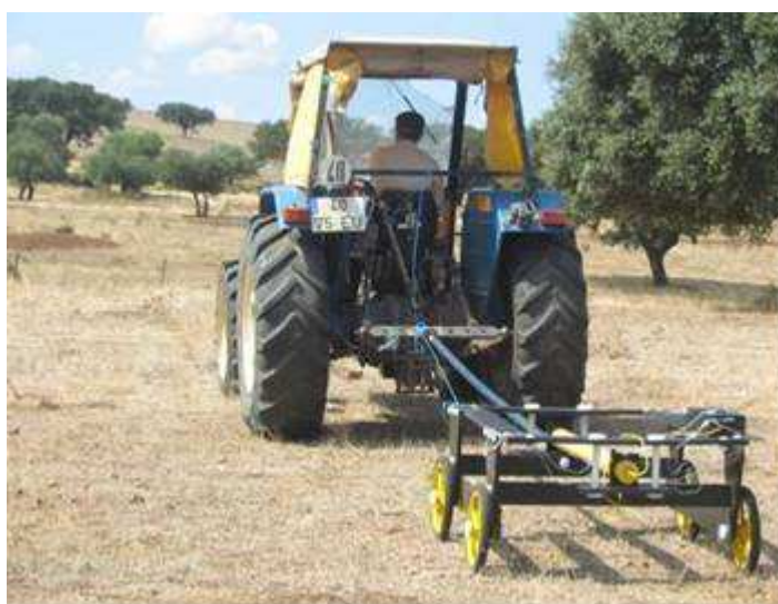
Figura 2- Medição da condutividade eléctrica com o sensor “DUALEM”.
