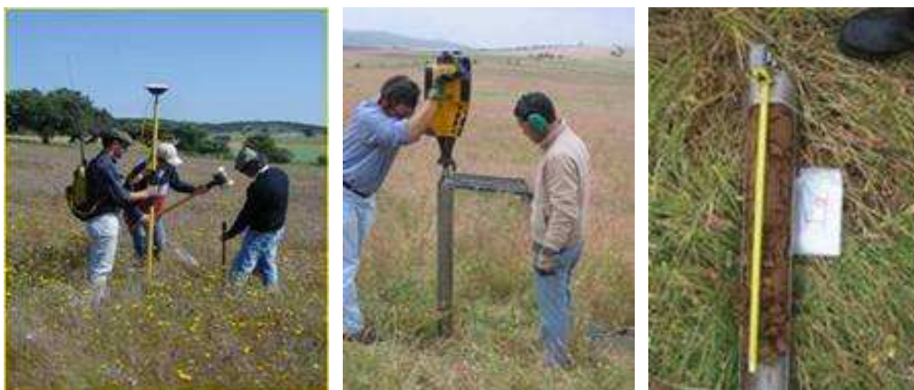
Figura 1- Recolha de amostras georreferenciadas com GPS RTK.
