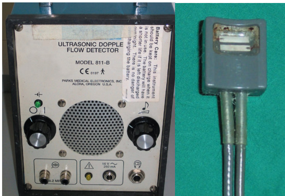
Figura 39 – Monitor doppler com respectiva sonda (adaptado de Flaherty & Musk, 2005).
