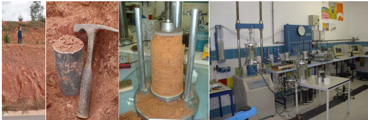
Figura 1. Colheita de amostra (A), processo de constituição de provetes (B) e equipamento triaxial utilizado (C).
