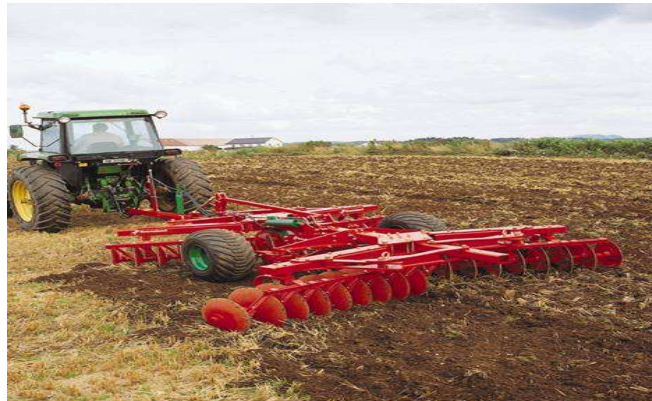
Fig. 17. Grade de discos a misturar restolho de cereal no solo
