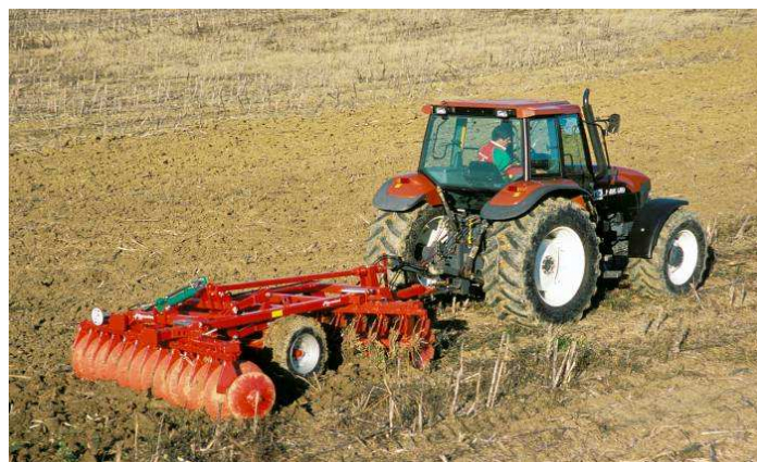
Fig. 11. Preparação da cama da semente com grade de discos
