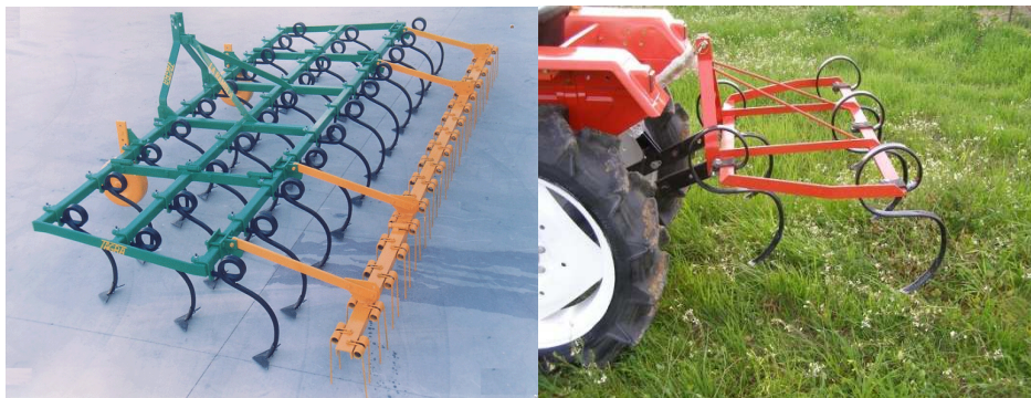
Fig.1. Escarificador de braços flexíveis com bicos extirpadores
