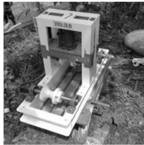
Gambar 3 : Mesin rol pipa dengan penekan dongkrak hidrolik (Jadhav, et al, 2015)
