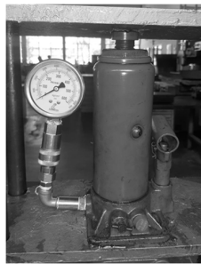
Gambar 8 : Modifikasi dongkrak hidrolik dengan pemasangan manometer pemantau tekanan hidrolik
