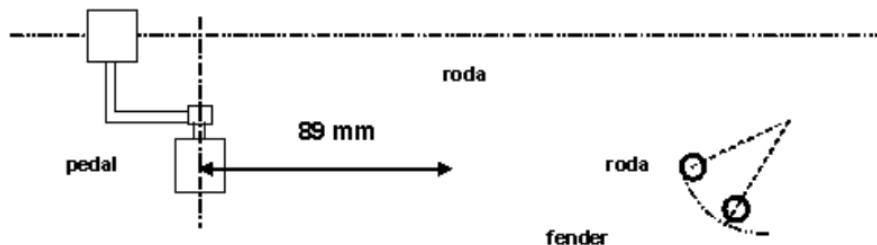
Gambar 2. 25 Jarak pedal engan roda depan – fender depan (Sumber : Standar Nasional Indonesia, 2008)
