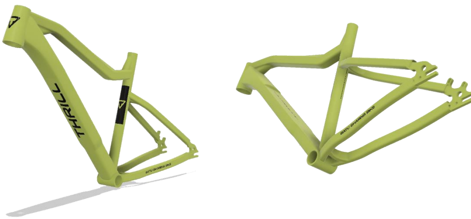
Gambar 6. 2 Frame dengan acuan diamond structure
