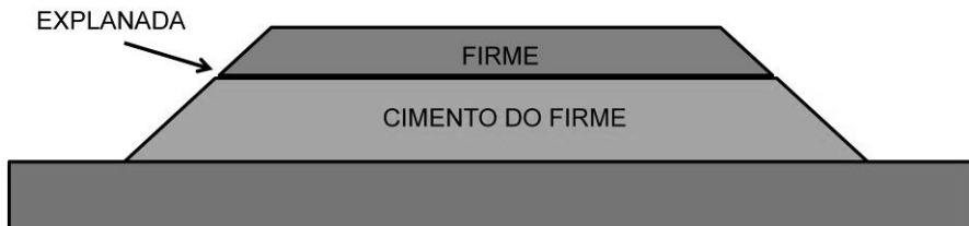
Figura 1.2: Esquema conceptual dunha sección de estrada co firme, a explanada e o cemento do firme
