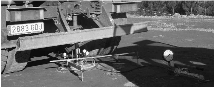
Figura 6.1: Execución dun ensaio de carga con placa
