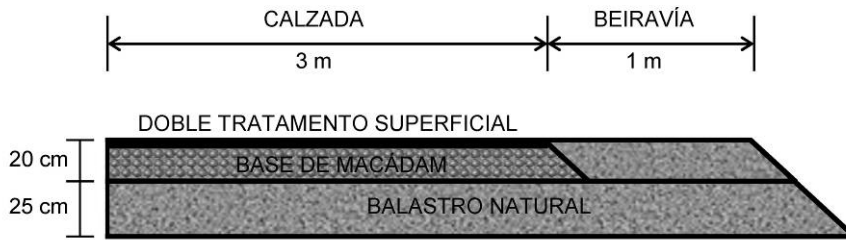
Figura 5.2: Exemplo de sección de firme flexible para intensidade baixa de tráfico pesado
