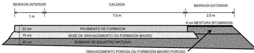
Figura 5.8: Exemplo de sección de firme rígido para intensidade elevada de tráfico pesado
