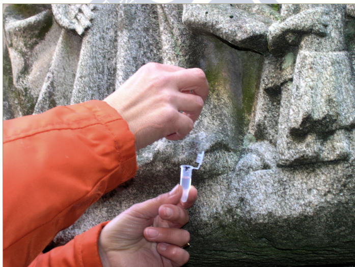
Figura 3. Se utilizan diferentes reactivos para una primera identificación in situ de los líquenes
