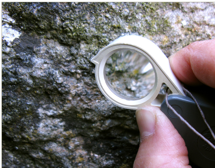
Figura 2. Lupa de campo utilizada para la identificación in situ
