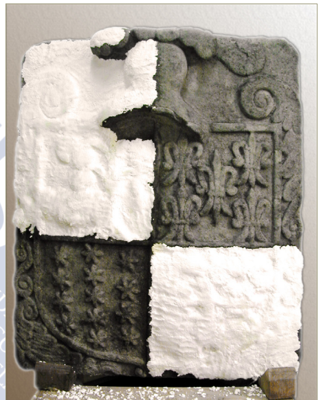
Figura 3. Limpieza mecánica y química –con biocidas– en uno de los laterales
