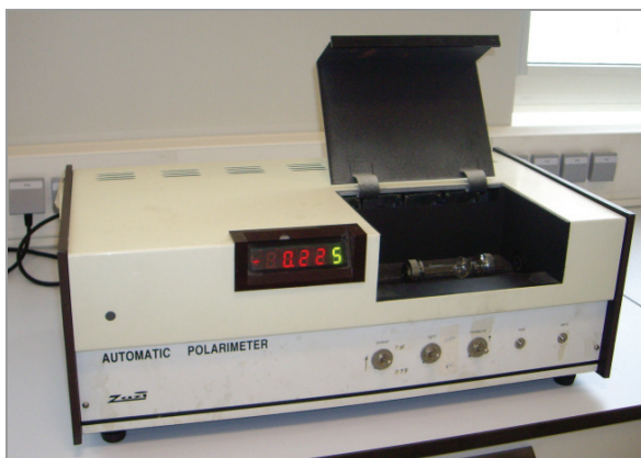
Figura 22. Polarímetro empregado para calcular a rotación óptica da 1-feniletilamina illada a partir da mestura racémica
