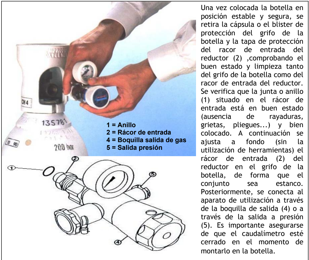
Figura 11.- Procedimiento de montaje de reductor en la botella de HELIOX.
