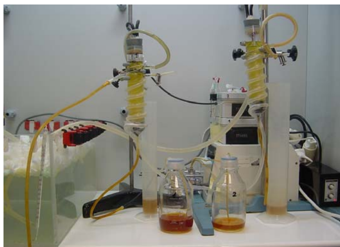
Figura 8.7. Reactores continuos para el tratamiento anaerobio del efluente de la degradación enzimática de Orange II
