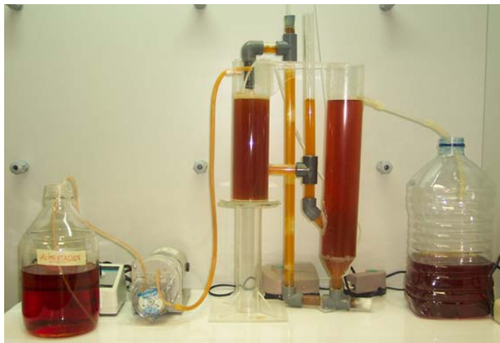
Figura 8.13. Reactor de lodos activos para el tratamiento aerobio del efluente de la degradación enzimática de Orange II
