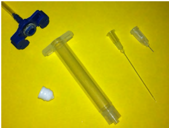
Figura 1.39: Imagen de la jeringa de 3\ \text{cm}^3 de volumen, pistón y agujas de diferentes diámetros ( 200\ \mu\text{m} y 1\ \mu\text{m} ) que se utilizan en DIW.
