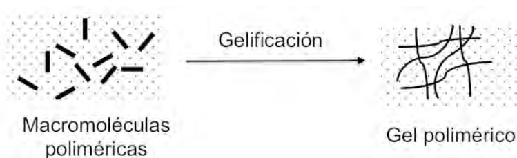
Figura 2.4: Proceso sol-gel mediante vía polimérica.
