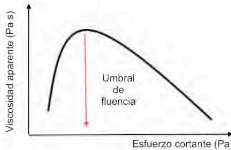
Figura 1.54: Curva utilizada en el ensayo para determinar el umbral de fluencia.
