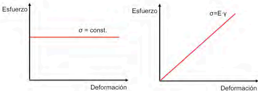
Figura 1.50: Ley de Newton (izquierda) y ley de Hooke (derecha). E = Módulo de elasticidad.
