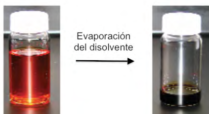
Figura 2.9: Aspecto de la tinta de titanio antes (izquierda) y después (derecha) de la evaporación del disolvente.
