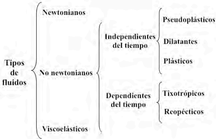
Figura 1.48: Esquema de los diferentes comportamientos reológicos de los materiales.
