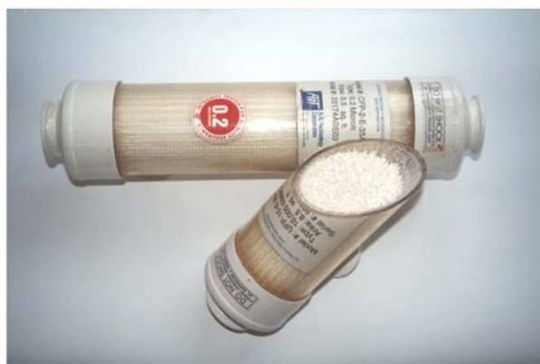
Figura II.5. Detalle de una de las membranas de microfiltración empleadas.
