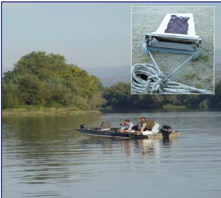
**FIGURA 23:** Embarcación y draga de arrastre utilizadas en la toma de muestras.
