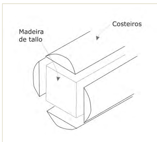
Fig. 3. 47. Esquema do primeiro corte ou desbaste.
