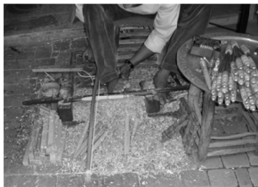
Fig. 3. 44. Contexto de produción de manufacturas de madeira, podemos observar o conxunto heteroxéneo de elementos: preformas, obxectos semielaborados e elaborados, desfeitos de produción, ferramentas, etc.
