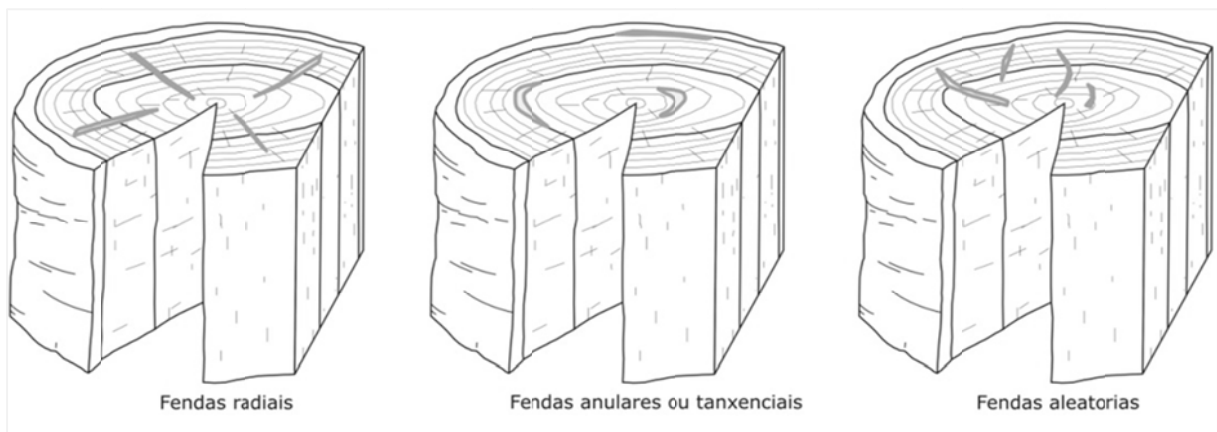
Fig. 3. 32. Tipos de fendas: radiais, anulares e arbitrarias.
