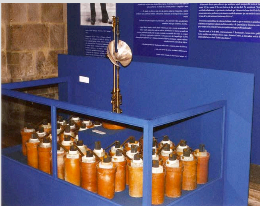
Fig.6.20. Pilas Bunsen e dispositivo do arco voltaico que formaron parte da Exposición “A noite está varrida da Terra” celebrada en Santiago en 2001, co gallo dos 150 anos do experimento.
