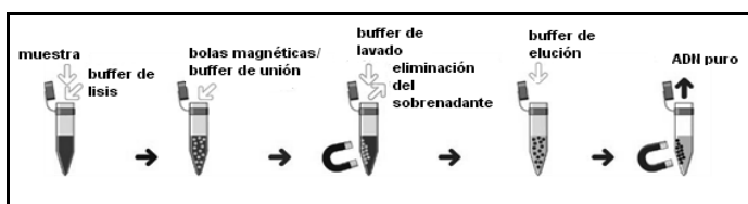
Figura 20: Varios pasos de la extracción usando nanopartículas magnéticas. (Berensmeier S, 2006, modificada).
