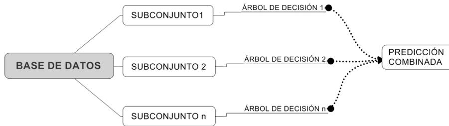
Figura 5.1: Funcionamiento del método BAGGING
