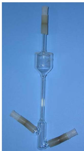
Fig. 8: Separador gas-líquido de salida forzada
