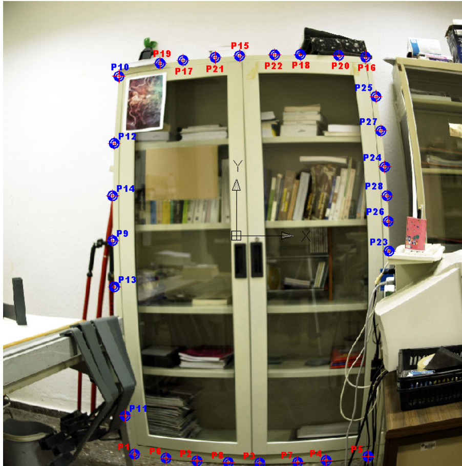
Figura 11: fotograma con los puntos medidos sobre las líneas rectas en una escena normal.
