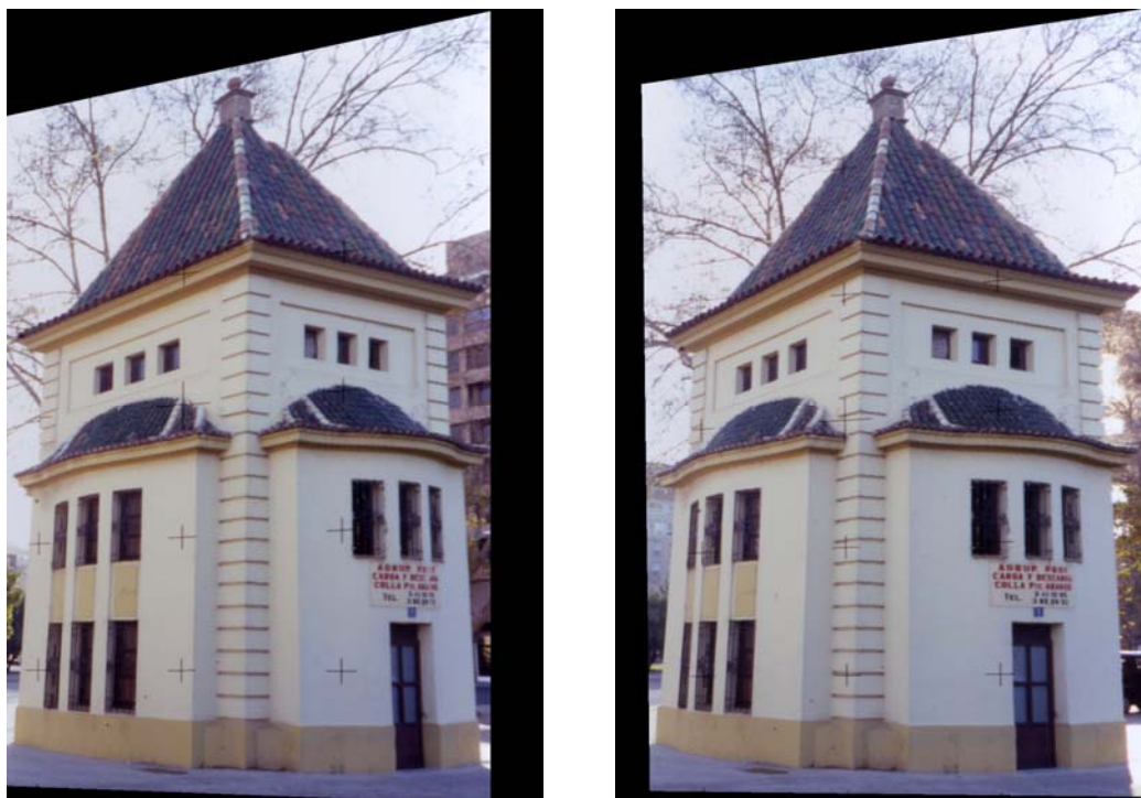
Figura 18: Fotogramas izquierdo y derecho epipolarizados del Templete de la Av. de Aragón (Valencia)
