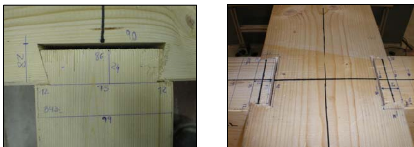
Figura 5.18. Toma de dimensiones reales de las piezas mecanizadas.
