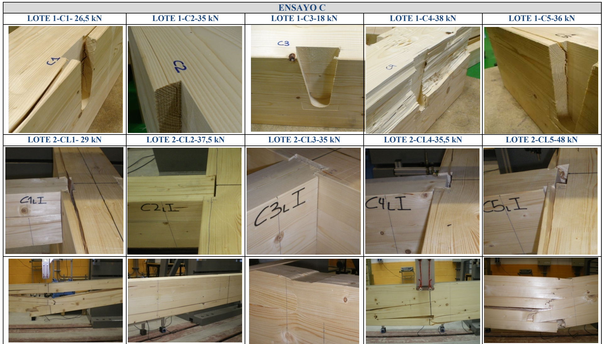
Figura 6.22. Detalles de rotura de los ensayos los ensayos C en los lotes 1 y 2.
