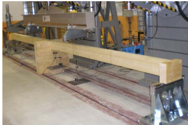
Figura 5.15. Distancia entre ejes de los apoyos y distancia de punto de aplicación de la carga al eje de la espiga del apoyo sobre la viga central
