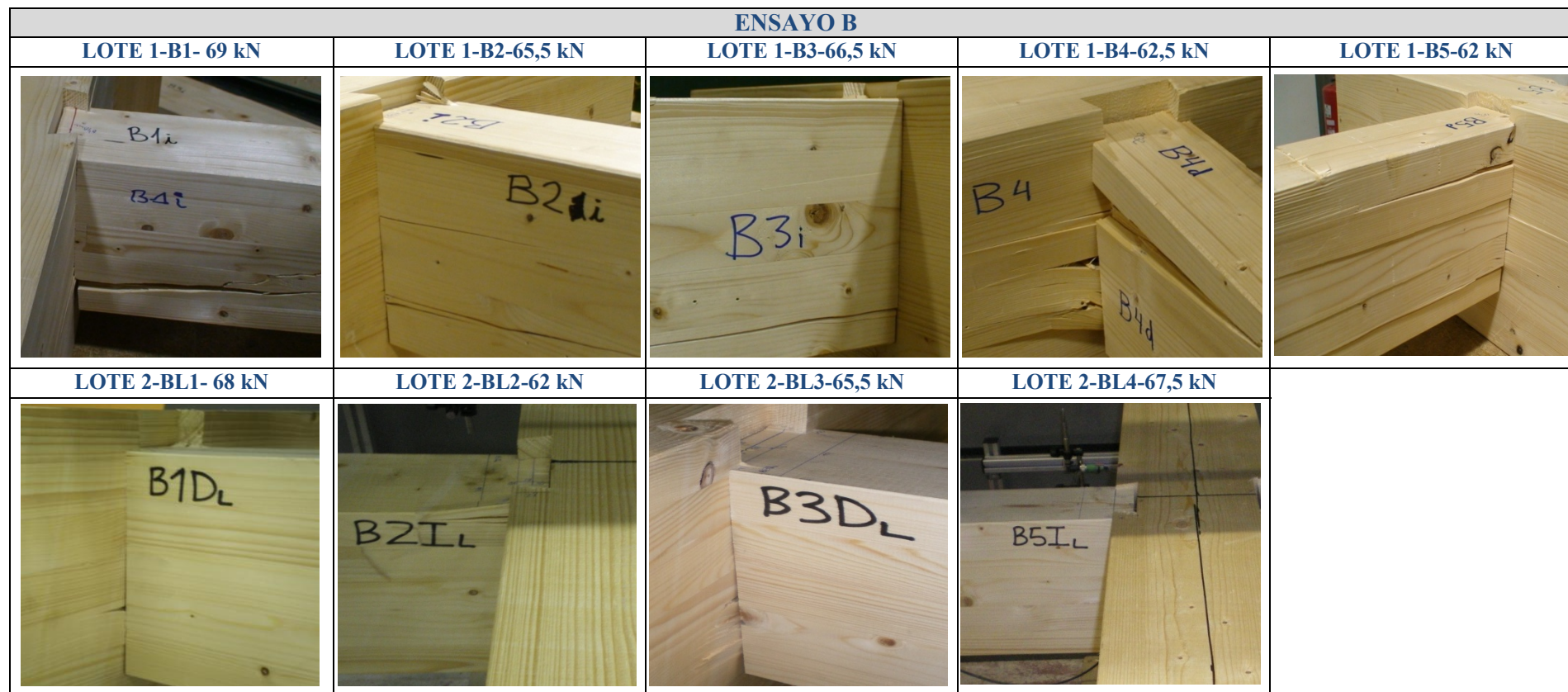
Figura 6.21. Detalles de rotura de los ensayos los ensayos B en los lotes 1 y 2.
