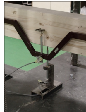
Figura 5.3. Pórtico de ensayos marca IBERTEST, modelo PELFIB 150W y extensómetros empleados.
