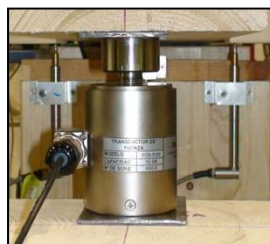
Figura 5.4. Transductor colocado en uno de los apoyos de la viga soporte
