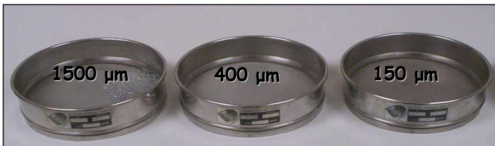
Figura 75.- Tamices utilizados en la filtración del contenido del aparato digestivo.
