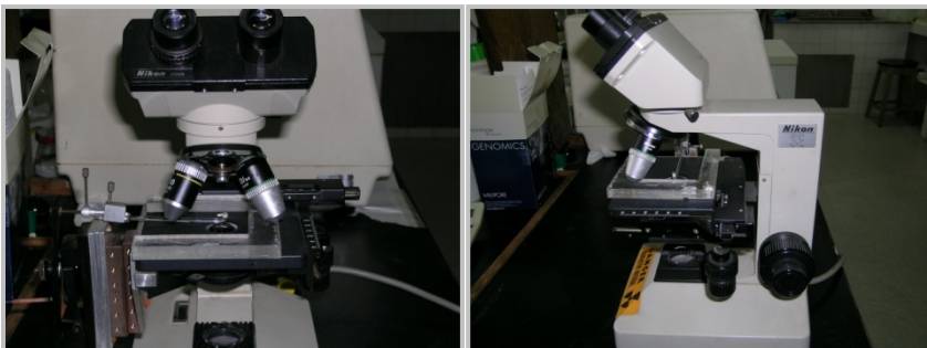
Figura 12. Micromanipulador “Micromanipulator II” (Allen Benjamin Inc.) acoplado a un microscopio Nikon SE (Figura 12).
