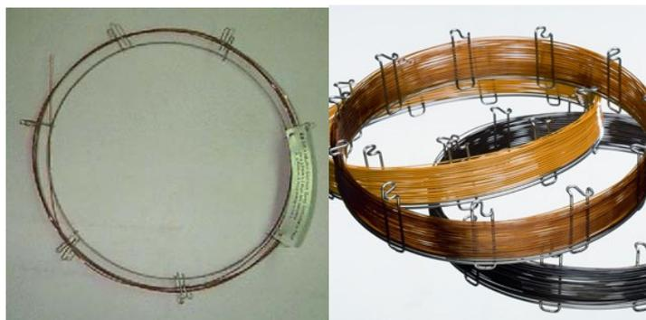
Fig. 8.18. Columnas capilares.
