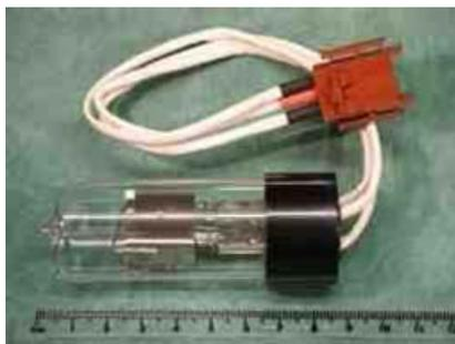
Fig. 5.19. Fuente de deuterio o hidrógeno.
