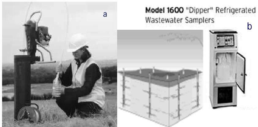
Fig. 2.11. Muestreo de aguas subterráneas a distintos niveles de profundidad (a) Muestreador con refrigeración de aguas residuales (b).
