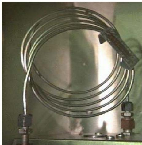
Fig. 8.17. Columna empaquetada o de relleno.
