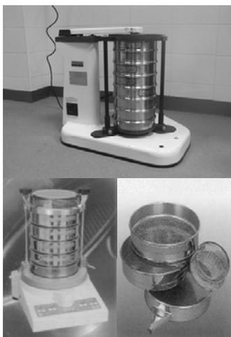
Fig. 2.16. Tamices utilizados para separar las partículas sólidas por tamaño.
