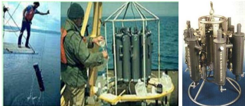
Fig. 2.8. Sistema de muestreo automático para muestras líquidas en movimiento.
