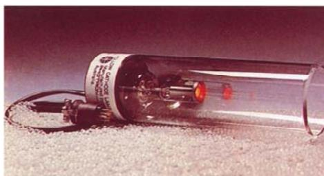
Fig. 7.19. Lámpara de cátodo hueco (abajo). Esquema de sección transversal (arriba).
