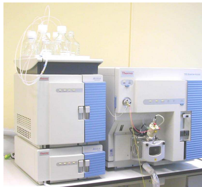
Figura I.B.2 Cromatógrafo de líquidos.
