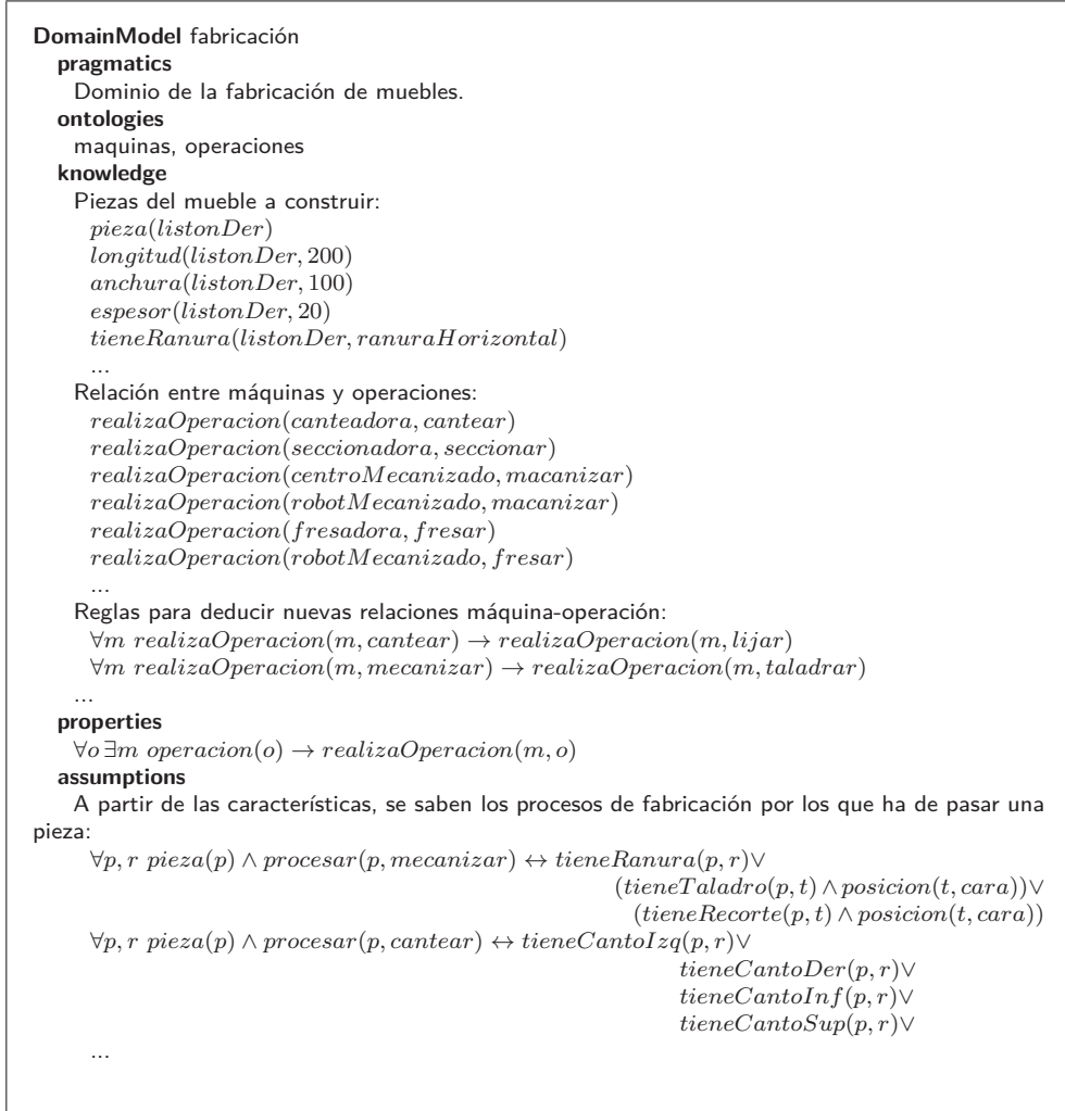
Figura 4.16: Ejemplo de modelo del dominio de fabricación en la industria del mueble
