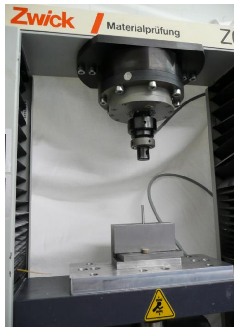
Figura 5.49. Dispositivo empleado para la rotura de los compactos formados acoplado a la prensa de ensayo de materiales Zwick.
