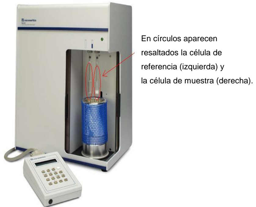
Figura 3.2. Modelo de la serie Gemini de Micromeritics utilizado para la determinación del área superficial.
