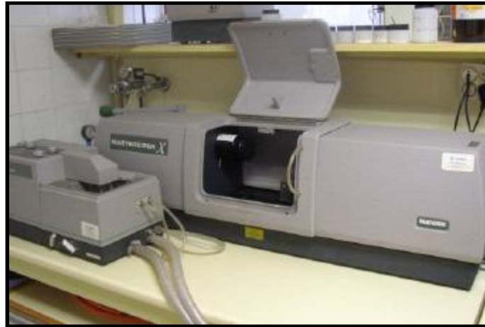
Figura 3.3. Difractómetro láser Mastersizer X empleado para analizar el tamaño de partícula de las muestras.
