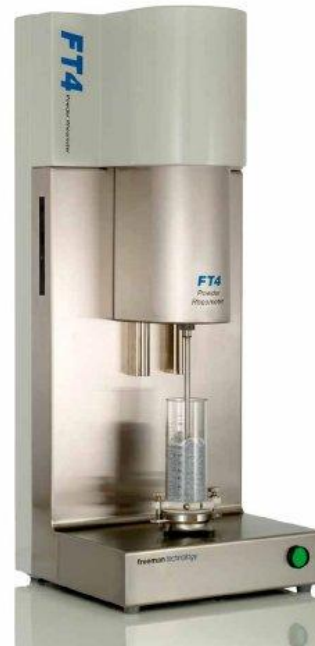
Figura 4.56. Representación de la forma de la hélice y el movimiento que realiza durante la etapa de consolidación. Reómetro Freeman FT4.
