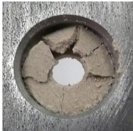
Figura 5.52. Aspecto del compacto una vez realizado el ensayo de resistencia.
