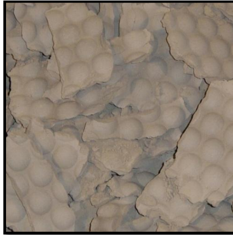
Figura 2.9. Plaquetas obtenidas a partir de carbonato cálcico mediante compresión entre rodillos moleteados.
