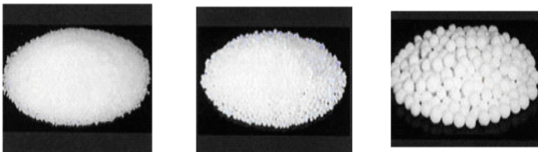
Figura 2.15. Imagen de distintos tamaños de gránulos de urea obtenidos mediante prilling.
