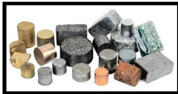
Figura 2.8. Distintos productos obtenidos mediante aglomeración por briqueteado de materiales pulverizados a elevada presión.
