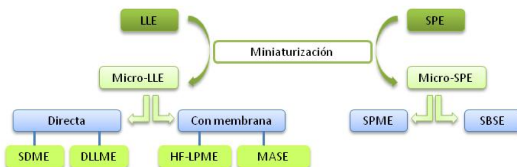
Figura II.6. Esquema de las técnicas de microextracción abordadas en este capítulo.
