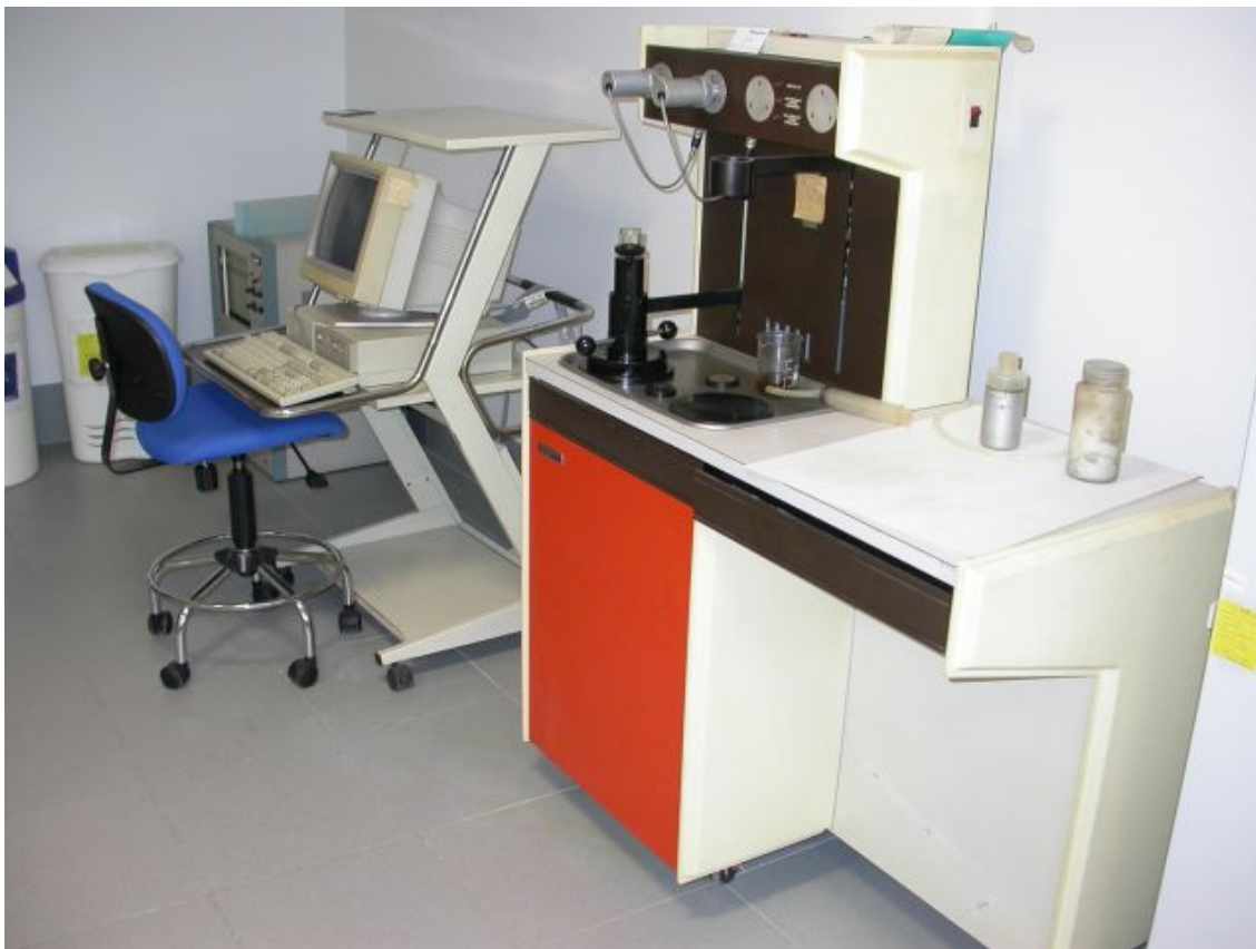
Figura 33.- Porosímetro y equipo informático utilizados para las mediciones.
