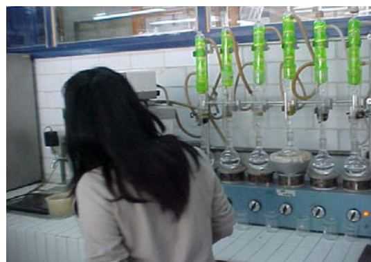
H. Proceso de extracción de 6 a 8 horas
