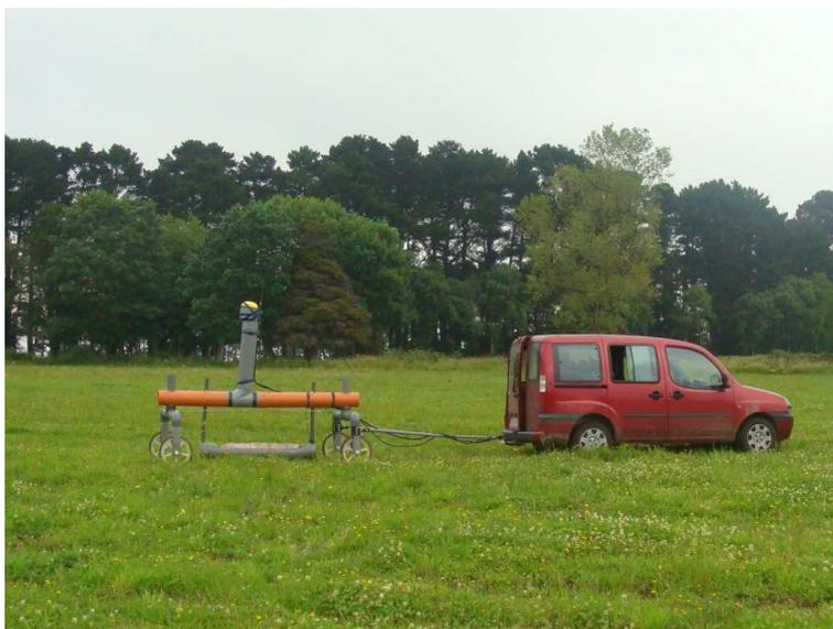
**Figura 13.** Equipo de medida de datos de la conductividad eléctrica aparente del suelo.
