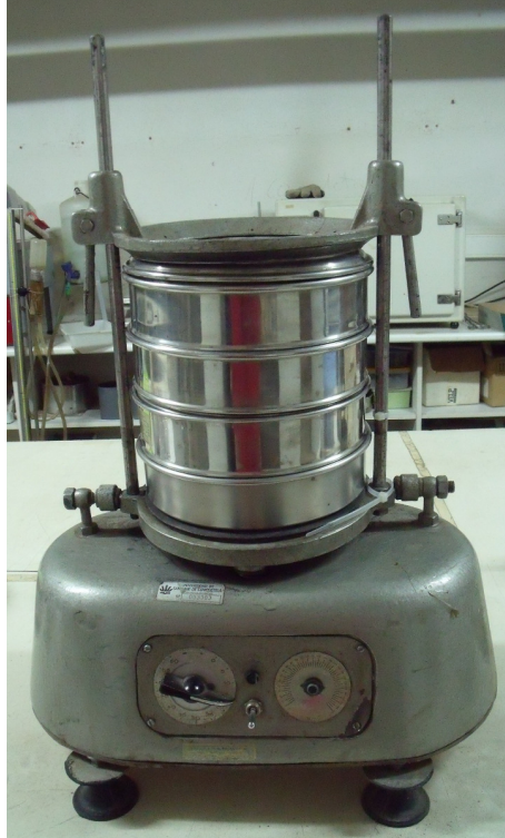
Figura 81. Axitador mecánico de tamices (Departamento de Edafoloxía e Química Agrícola, Facultade de Farmacia).
