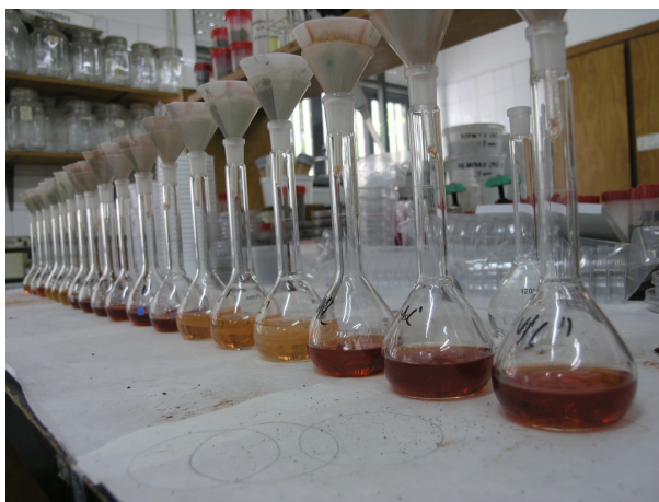
Figura 42. Extracción do TPF formado durante a determinación da actividade dehidroxenasa en compost.
