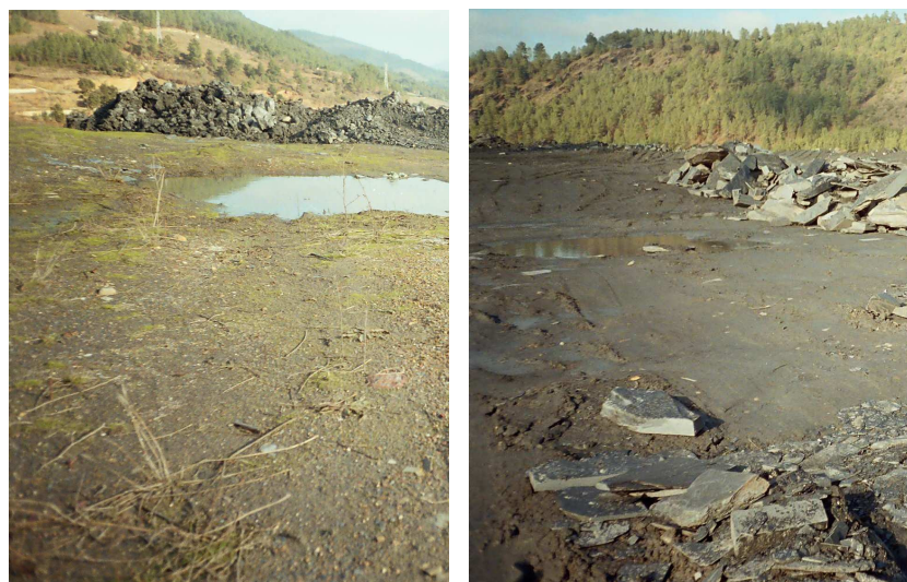
Figura 98. Lixeira colonización espontánea na zona non compactada dunha entulleira de lousa (esquerda), e zona compactada polo tránsito de maquinaria na mesma entulleira (dereita). Ambas imaxes corresponden á entulleira de ANPEAL (O Barco de Valdeorras, Ourense).
