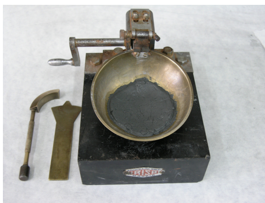
Figura 89. Culler de Casagrande e acanaladores utilizados para a determinación do límite líquido (Departamento de Edafoloxía e Química Agrícola, Facultade de Farmacia).
