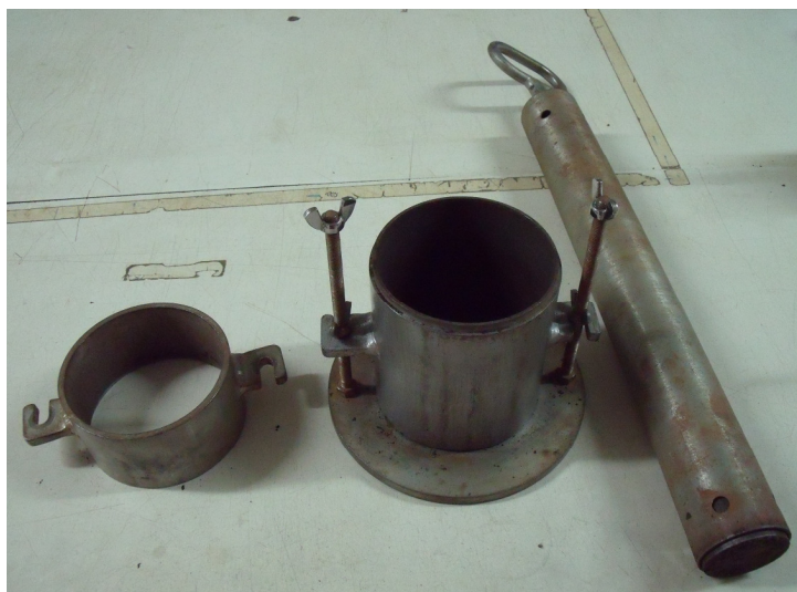
Figura 91. Molde e maza para o ensaio de compactación Proctor (Departamento de Edafoloxía e Química Agrícola, Facultade de Farmacia).
