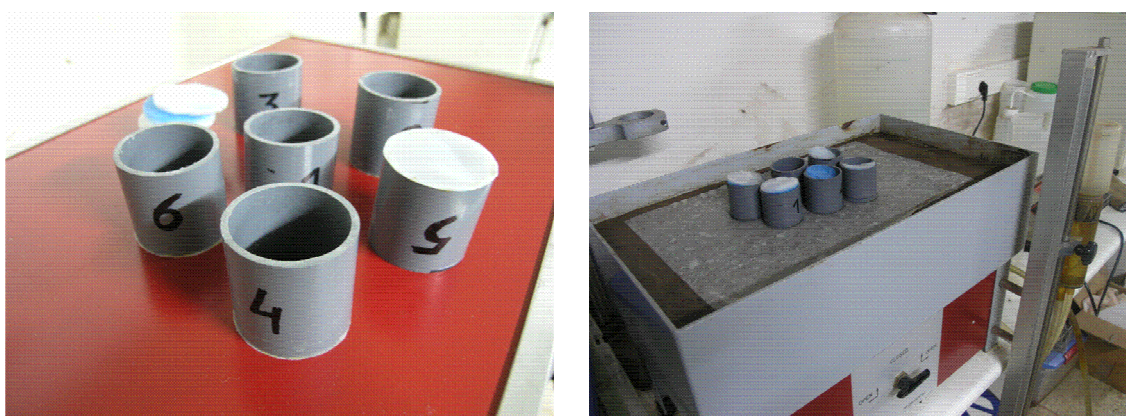
Figura 83. Esquerda: aneis de PVC fabricados para a determinación de humidade en solos en leito de area; dereita: leito de area durante a medida (Departamento de Edafoloxía e Química Agrícola, Facultade de Farmacia).
