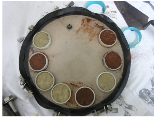
Figura 85. Mostras saturándose na placa porosa para a determinación da capacidade de retención de auga (Departamento de Edafoloxía e Química Agrícola, Facultade de Farmacia).
