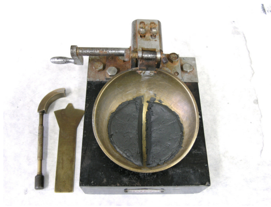
Figura 90. Mostra de lodos de lousa preparados para a determinación do límite líquido na culler de Casagrande.
