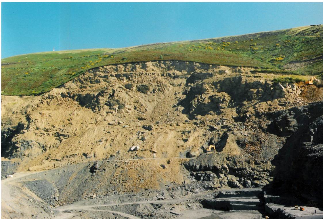
Figura 24. Vista xeral dunha explotación de lousa na que se aprecia o desmonte de terreo para chegar ao filón explotable (Carballada de Valdeorras, Ourense).
