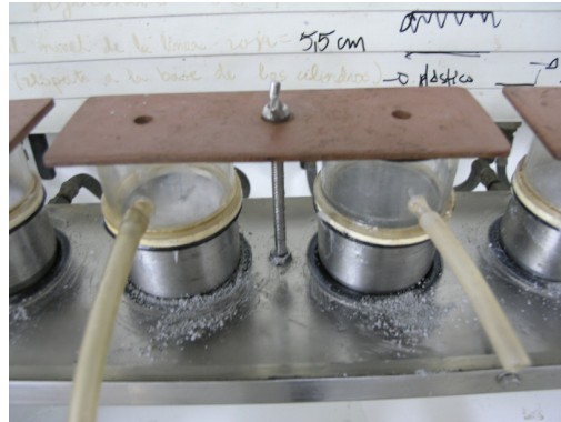
Figura 88. Detalle da montaxe para a medida da condutividade hidráulica. (Departamento de Edafoloxía e Química Agrícola, Facultade de Farmacia).
