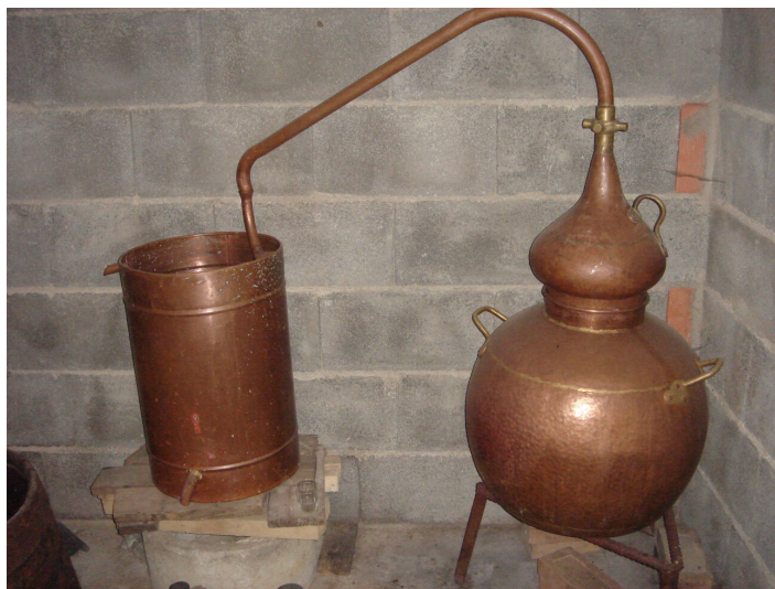
Figura 3. Alambique tradicional utilizado para a destilación de bagazo de uva. Fotografía: D. Álvarez.
