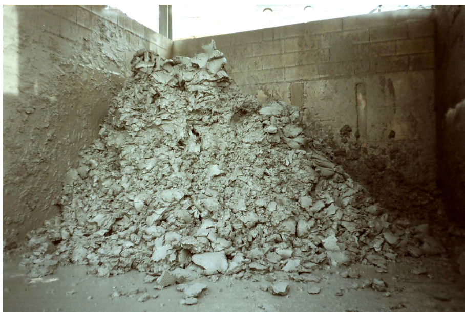
Figura 77. Lodos de lousa producidos na nave de elaboración unha vez saídos do filtro-prensa (Carballeda de Valdeorras, Ourense).
