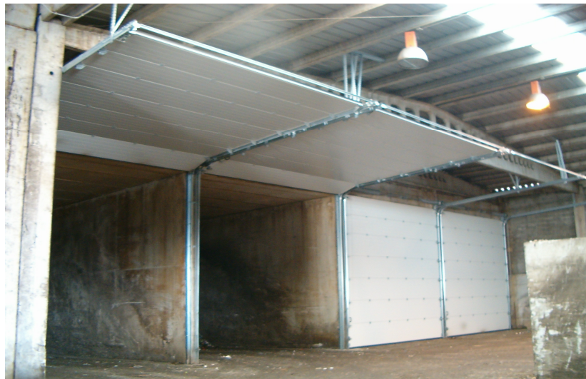
Figura 8. Túneles de compostaxe no Complexo Medioambiental do Barbanza (FCC, Lousame). Fotografía: M.T. Barral.
