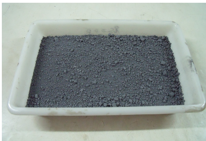
Figura 93. Aspecto dos lodos de lousa no laboratorio.
