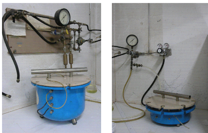
Figura 84. Extractores utilizados para a medida da capacidade de retención de auga: á esquerda extractor de baixa presión, e á dereita extractor de alta presión (Departamento de Edafoloxía e Química Agrícola, Facultade de Farmacia).
