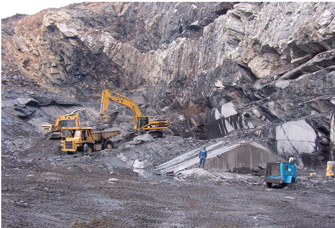
Figura 19. Canteira de extracción de lousa en Carballeda de Valdeorras (Ourense): obsérvese a extracción da rocha en frontes escalonadas. Fotografía: V. Cárdenes.
