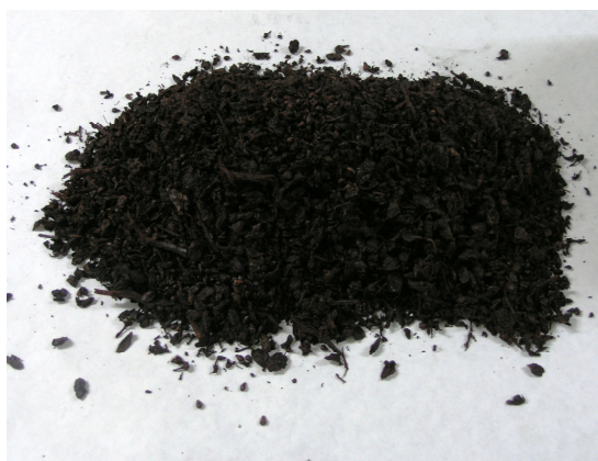
Figura 33. Bagazo esgotado de uva hidrolizado.
