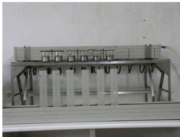
Figura 86. Sistema utilizado para medir a condutividade hidráulica saturada de solos no laboratorio (Departamento de Edafoloxía e Química Agrícola, Facultade de Farmacia).
