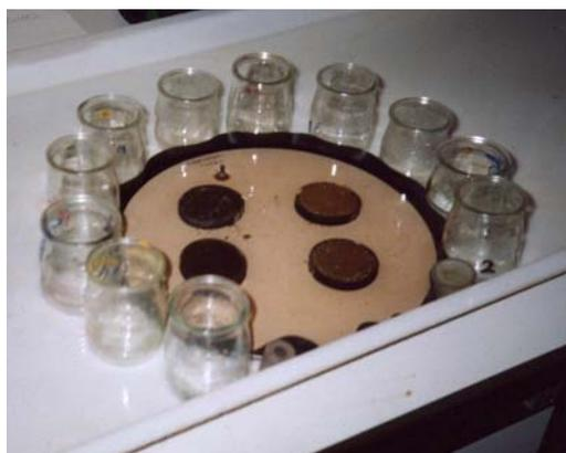
*Figura V.2. “Placa porosa con muestras durante el periodo de saturación o humectación”*
