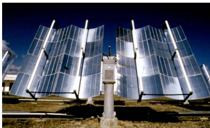
Figura 1.18. Colector cilindro-parabólico con seguimiento en dos ejes instalado en la PSA.
