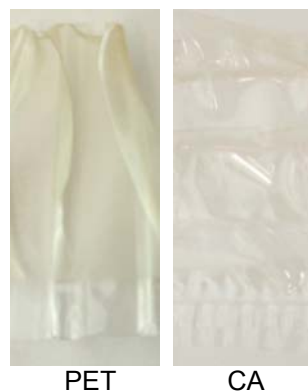
Figura 3.19. Polímeros tras 300 horas de envejecimiento acelerado (borde inferior no expuesto, para comparación).
