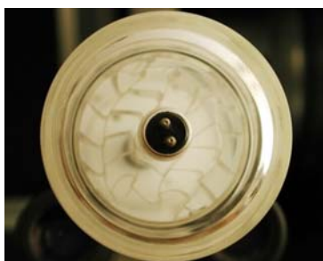
Figura 2.9. Vista frontal del reactor abierto con un monolito de PET.
