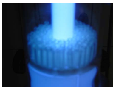
Figura 2.10. Vista del reactor con 110 anillos de vidrio borosilicato irradiados.
