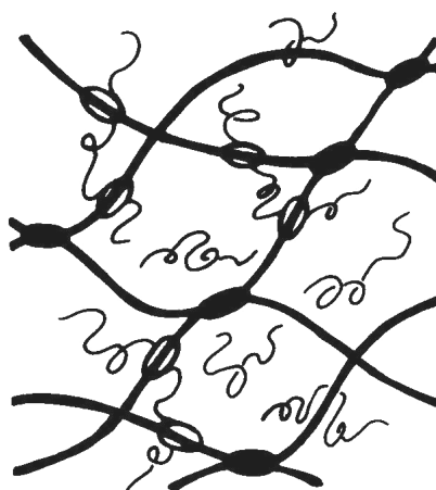
Figura 1.19. Estructura del gel mixto de carragenano y glucomanano. Las líneas gruesas representan las cadenas de carragenano y las finas las de glucomanano (Kohyama y cols. 1993).
