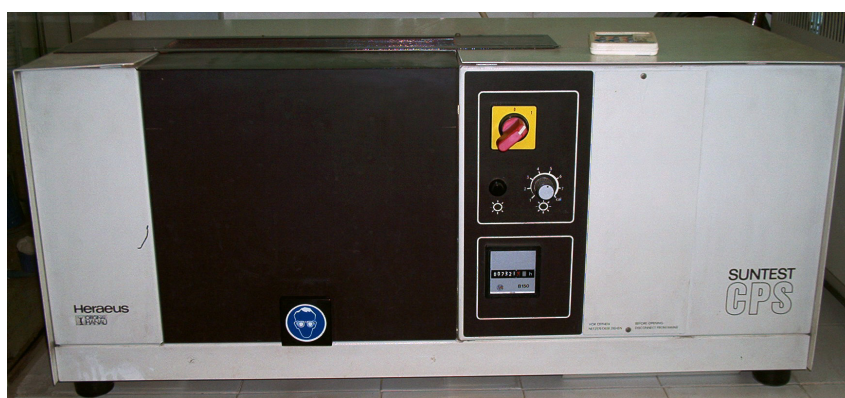
Figura III.4. Disposición de la fibra en el simulador solar y simulador solar Suntest.
