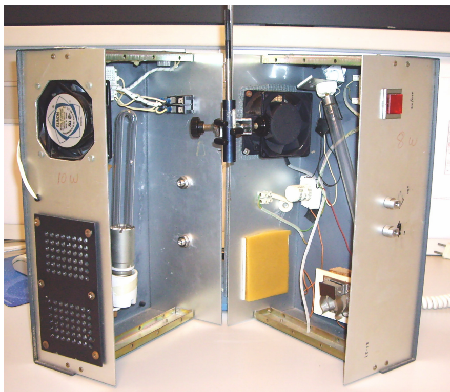
Figura III.3. Disposición de la fibra en el fotorreactor y fotorreactor con lámparas UV.
