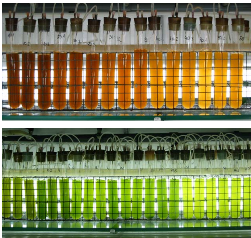
Figura 1. Sistema de cultivo de microalgas en fotobiorreactores de 80 ml. Isochrysis aff. galbana Clon T-ISO (arriba) e Nannochloropsis gaditana (abaixo).
