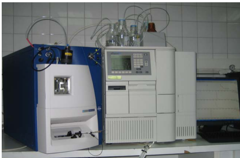
Figura 12. Fotografía del equipo empleado en el desarrollo de la metodología analítica para la determinación de antidepresivos (cromatógrafo de líquidos y espectrómetro de masas en tandem).
