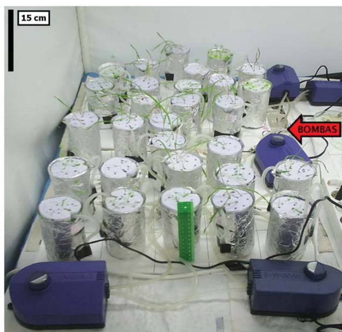
Foto 5.1. Aspecto general de las macetas de vidrio del tratamiento CONTROL y el tratamiento HCH en la cámara de cultivo. La flecha indica la colocación de las bombas que mantenían el flujo de oxígeno en las macetas.
