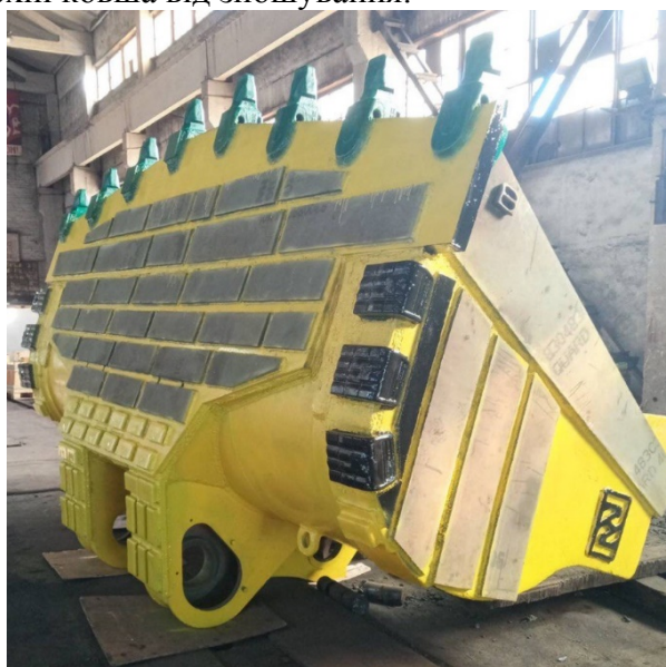
Рис. 2 Ківш навантажувача «Caterpillar» ємністю 15 м 3 , зміцнений зносостійкими листами і біметалевими армуючими елементами (світлого кольору)
