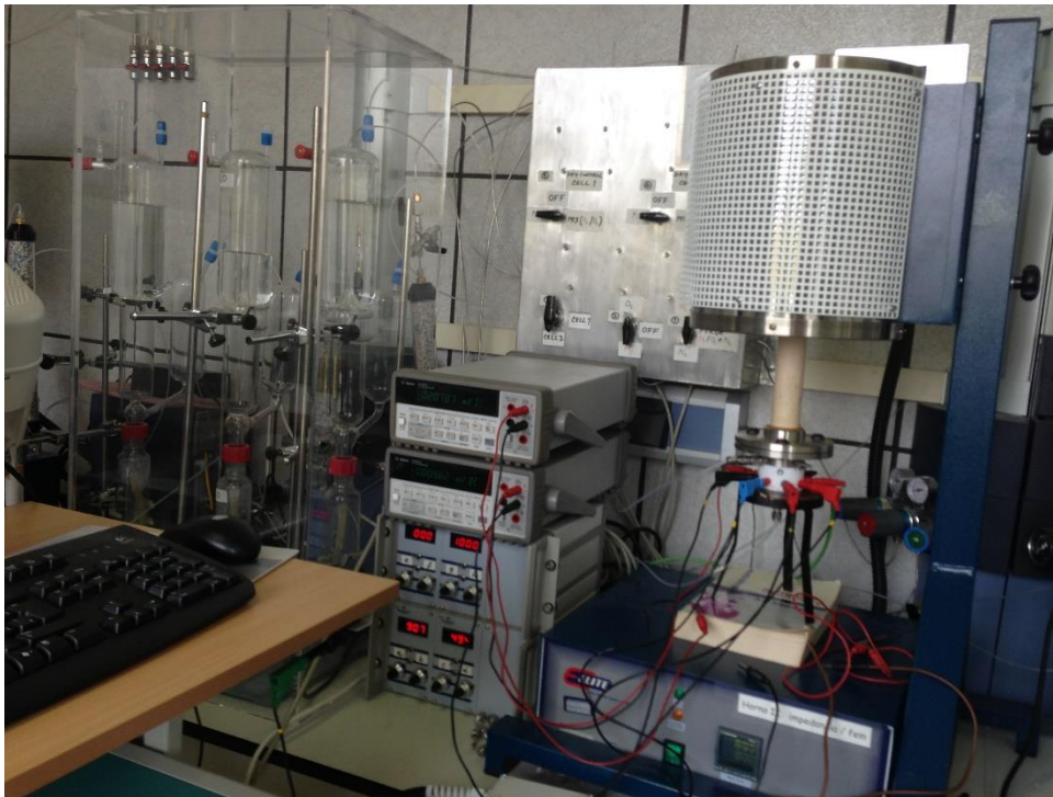
Figura. 4.11. Montaje experimental para la determinación del número de transporte del material mediante el método modificado de fuerza electromotriz.
