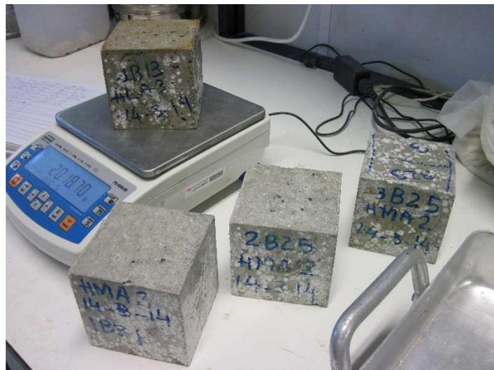
Figura 26. Pesado de probetas de hormigón, cálculo densidades.
