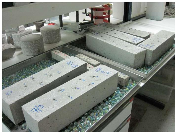
Figura 30. Probetas de hormigón endurecido acopiadas para el control por pérdida de peso.
