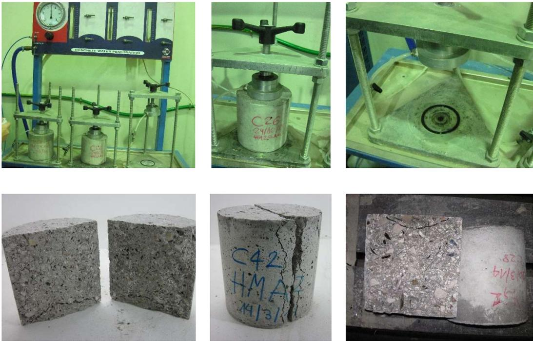
Figura 29. Ensayo de permeabilidad al agua. Probetas resultantes del ensayo a tracción una vez sometidas a agua a presión.
