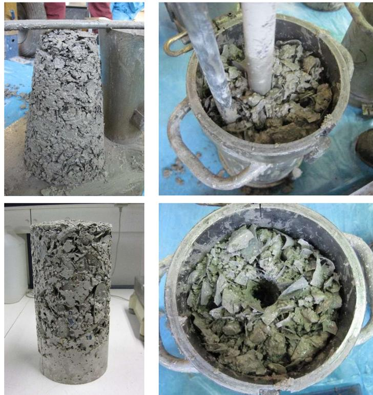
*Figura 33. Hormigones descartados por consistencia.*
