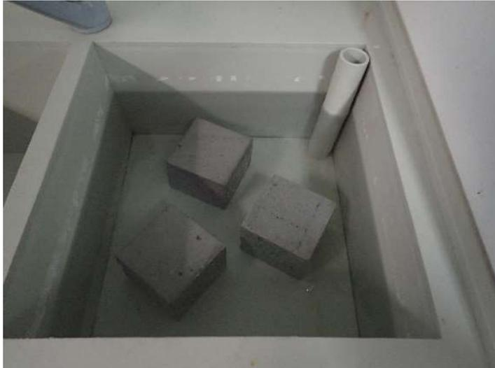
*Figura 27. Inmersión probetas cúbicas en agua, ensayo absorción.*
