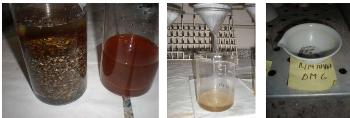
Figura 15. Ensayos químicos para áridos (Izq. Materia orgánica, Cent. Sulfatos solubles, Der. Contaminantes ligeros)
