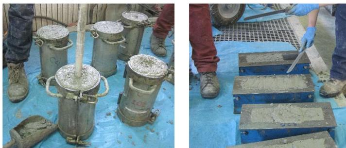
*Figura 23. Vibrado y enrasado del hormigón en los moldes.*
