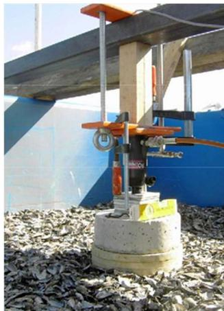
Figura 10. Ensayo de carga sobre bañera de conchas de mejillón. (41)
