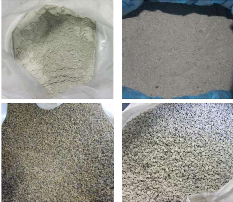
Figura 13. Materiales empleados en la fabricación de los hormigones. Cemento, arena, gravilla y grava natural.
