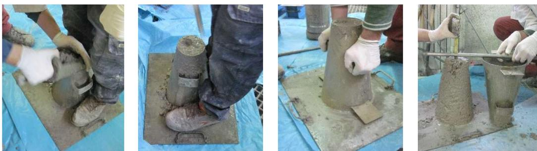
*Figura 24. Medida de la consistencia mediante cono de Abrams.*
