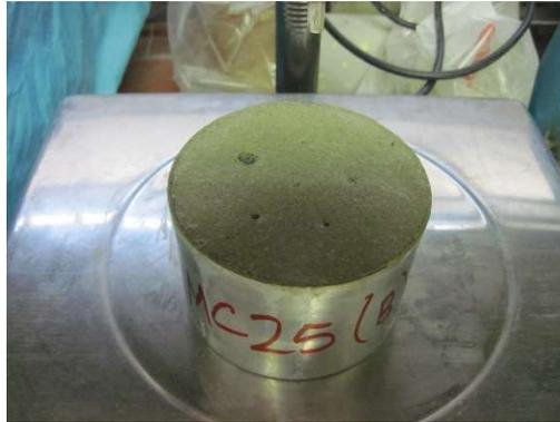
Figura 25. Probeta de ensayo del tiempo abierto de trabajabilidad sobre mortero de cemento con sustitución del 25% de la arena natural por arena de mejillón.
