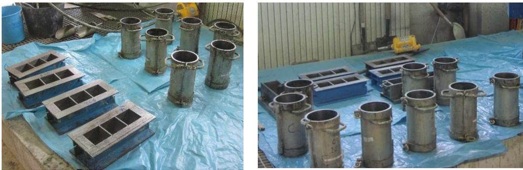
Figura 22. Moldes para la elaboración de probetas de hormigón de limpieza y hormigón en masa estructural respectivamente.
