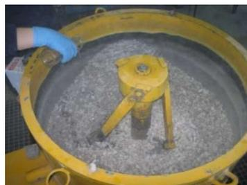
Sin parar la amasadora se añade agua hasta saturación del árido al 80%. Se mezcla durante 30s
