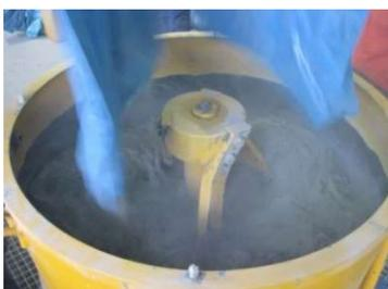
Se para la amasadora y se introduce el cemento. Se pone en marcha de nuevo durante 60s.
