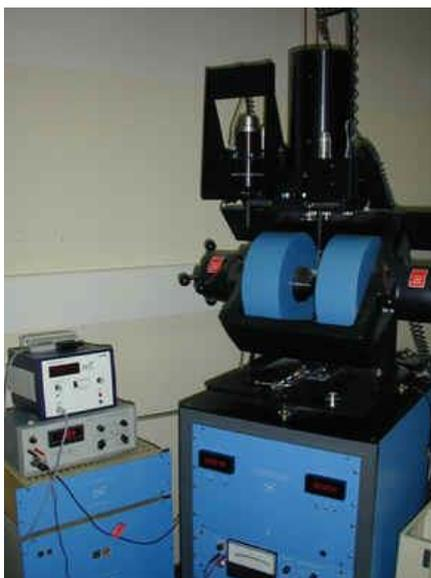
Figura 18: Magnetómetro de muestra vibrante modelo DMS-1660.<sup>[6]</sup>
