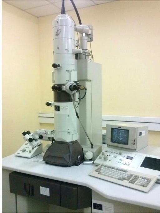
**Figura 16:** Microscopio electrónico de transmisión JEOL JEM 1010.
