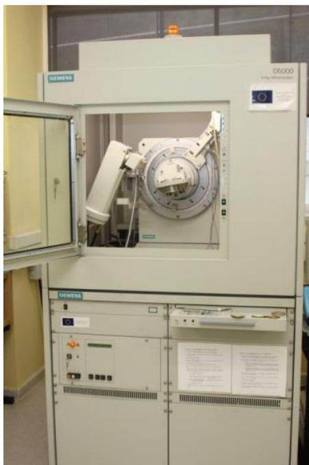
Figura 14: Difractómetro D5000 Siemens.<sup>[4]</sup>
