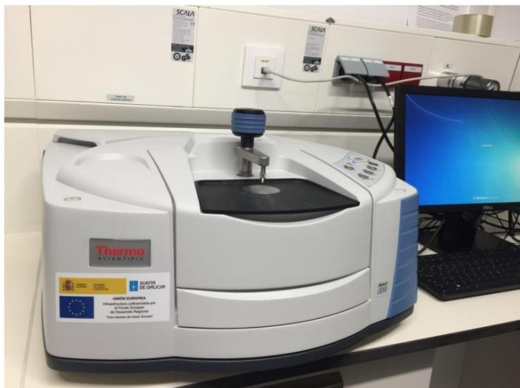
**Figura 15:** Espectrofotómetro Thermo Scientific Nicolet iS10 con módulo FT-IR Thermo Scientific™ Nicolet iZ™10 externo
