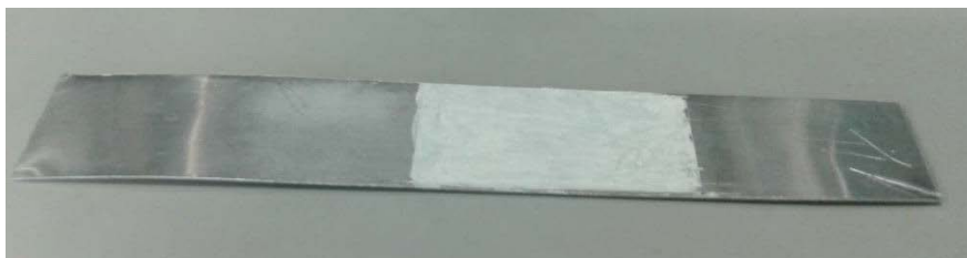
Imagen 3.3. Nanopolvo de ZnO adherido a la placa metálica en una zona de 6x3 cm.
