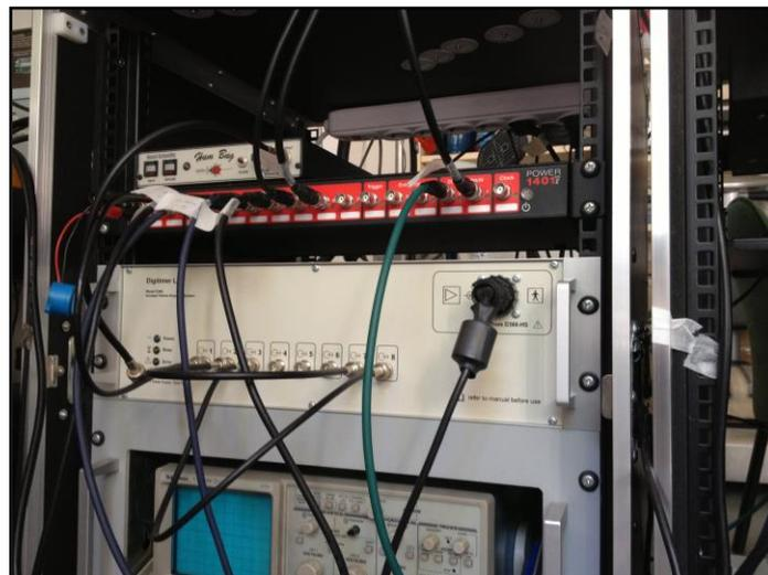
Figura 6: Amplificador y sistema de control analógico digital
