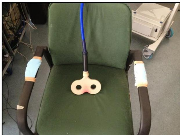
Figuras 2 y 3: Estimulador magnético y bobina (coil) respectivamente.
